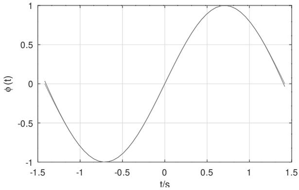
Abbildung 2.5: Ergebnis der Momentenmethode mit 3 Stützstellen im Vergleich zur exakten Lösung. Wertebereich der Stützstellen:  $[0.1 \cdot t_0 \dots t_0]$
