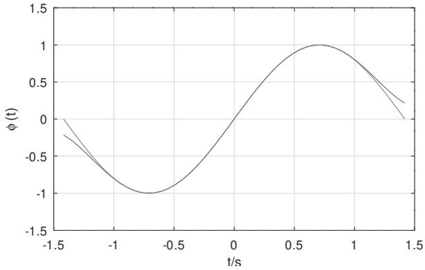
Abbildung 2.2: Ergebnis der Momentenmethode mit 5 Stützstellen im Vergleich zur exakten Lösung. Wertebereich der Stützstellen:  $[-t_0 \dots t_0]$
